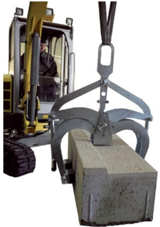
Mit der robusten Optimas „Mini“ Versetzzange können Steine oder Teile bis 360 mm Einstellbreite und 550 kg Gewicht gehoben werden. (Foto: Optimas GmbH)
