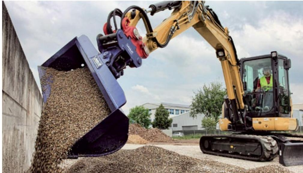
Wendig und flexibel mit der Lehnhoff 3er-Kombi aus vollhydraulischem Variolock-Schnellwechsler, Symloch-Adapter und Schwenklöffel. (Foto: Lehnhoff Hartstahl GmbH & Co. KG)
