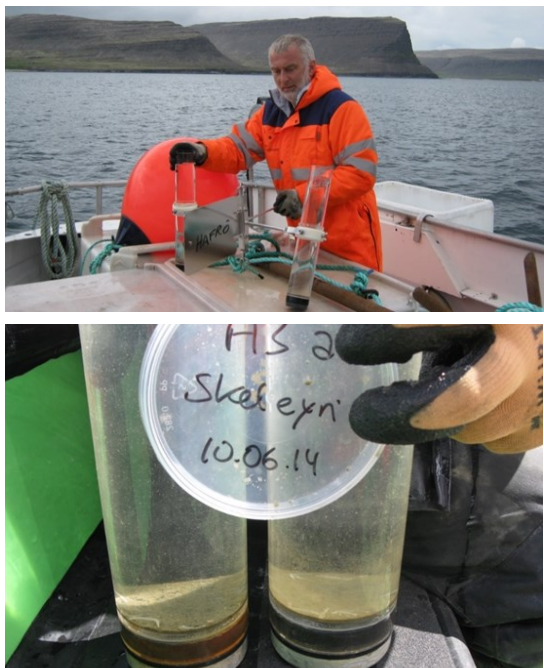
2. mynd. Efri myndin sýnir setgildru sem verið er að gera klára og sú neðri sýnir endurheimtar setgildir frá stöð A1 á fyrsta söfnunartímabilinu. (Myndir: Búi Bjarnason og Elísabet Kjartansdóttir).
