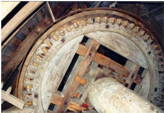
Die Stiftung vergibt eine Zuwendung für die Erneuerung der Verkämmung des Kamrades und des Bunkels im Getriebe des Windantriebs.
