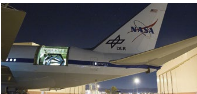
Das Teleskop ist im hinteren Teil des Jumbos eingebaut.
