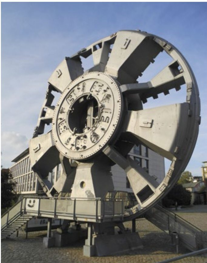
Bohrkopf der „Trude“, des Tunnelbohrers, der half, den Neuen Elbtunnel zu graben. Foto: Jürgen Petersen.
