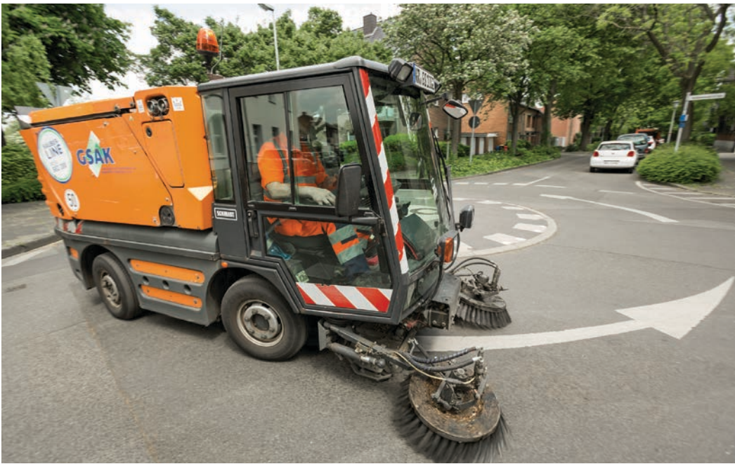
Kleine Kehrmaschine: Daniel Jansen (28) steuert die kleine Kehrmaschine, eine Schmidt Swingo, mit der er Straßenrinnen, Radwege und Bürgersteige reinigt.
