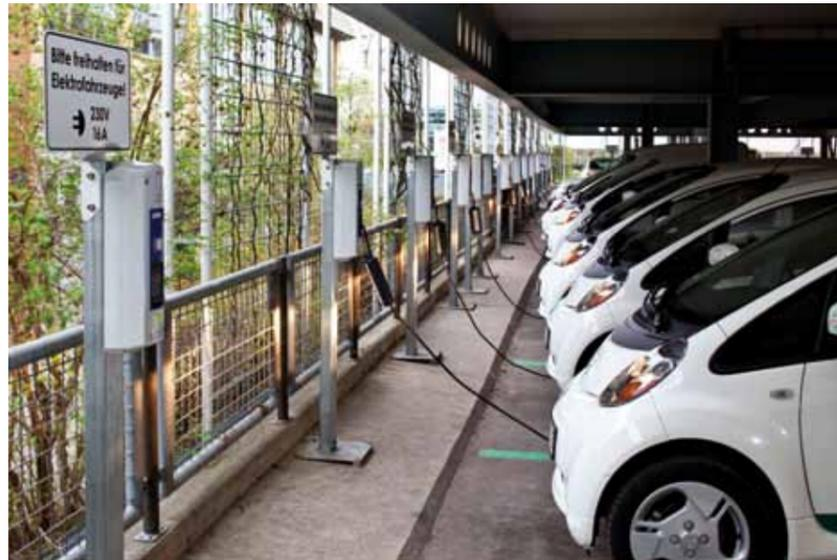
Abbildung 40: Mode-2-Laden im Parkhaus des IZS (Fahrzeuge im Bild: Mitsubishi i-MiEVs)<sup>54</sup>
