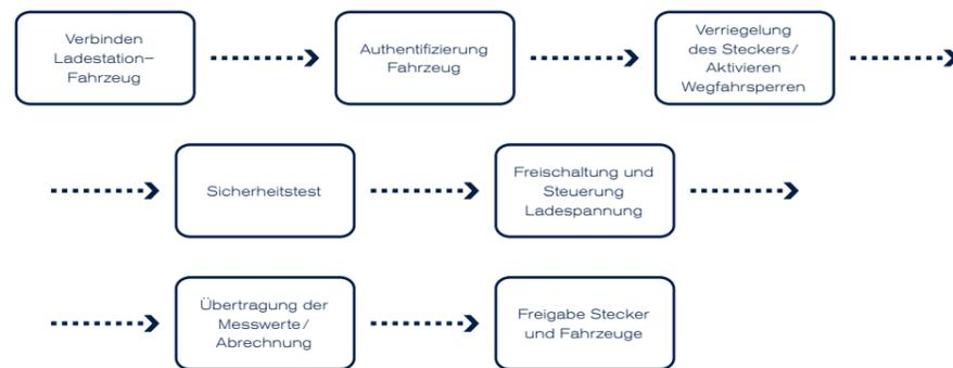
Abbildung 13: Idealer Ladevorgang eines Elektrofahrzeugs (mit Mode 3)
