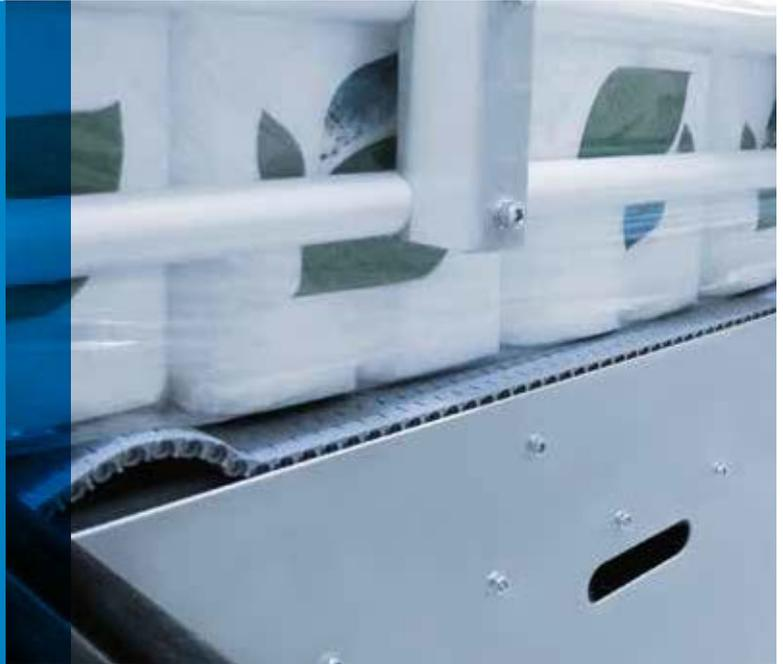
Optimale Ausrichtung des Lagenlayouts auf dem Gliederförderband (1); die Welle entsteht von zwei Seiten auf dem Gliederförderband. Währenddessen wird die spurgeführte Carbon-Rollenmatte unter die Lage geführt (2), die Carbon-Rollenmatte hebt die Produkte im Rahmengerüst leicht an (3) und setzt die Produktlage mithilfe des Roboterarms um (4).
