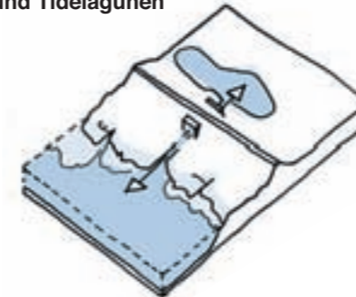
Überlauf und Flutpolder / Flutkammern
