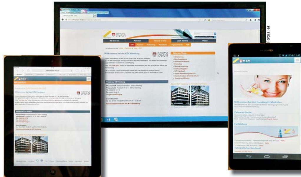
Die Website von KZV und Kammer wurde für den Zugriff mit Tablet (links) und Smartphone (rechts) optimiert. Auf diesen Geräten wird beispielsweise das mehrspaltige Design der Seite auf eine Spalte umgebaut. Automatisch. Die Schalterleiste liegt etwas versteckt. Mehr zum neuen Responsive Webdesign auf den Seiten 4 und 6.
