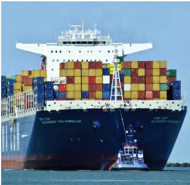
Nur mit Unterstützung von Schleppfahrzeugen gelangen große Containerschiffe sicher an ihren Liegeplatz (Bild oben). Am Bug des Frachtschiffes kontrolliert der Schlepper den Kurs.
