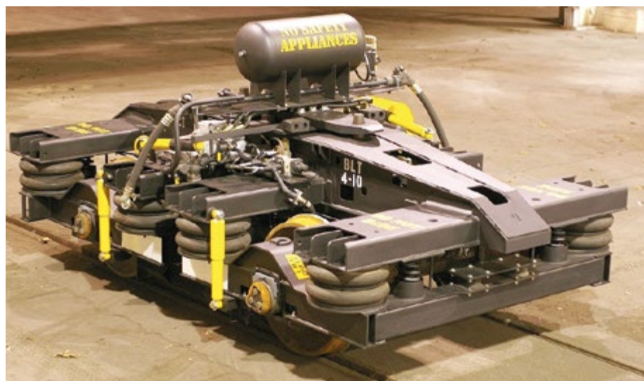
Das Drehgestell (Bogie) mit den schrägen Aufnahmen für die Anhänger
