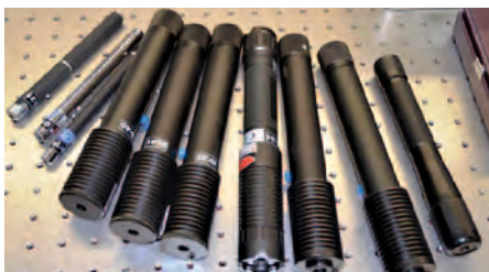
Laserpointer im Vergleich: Im Rahmen der Studie wurden gängige Modelle überprüft. Oft liegt die Leistung weit über der vom Hersteller angegebenen Höchstgrenze.
