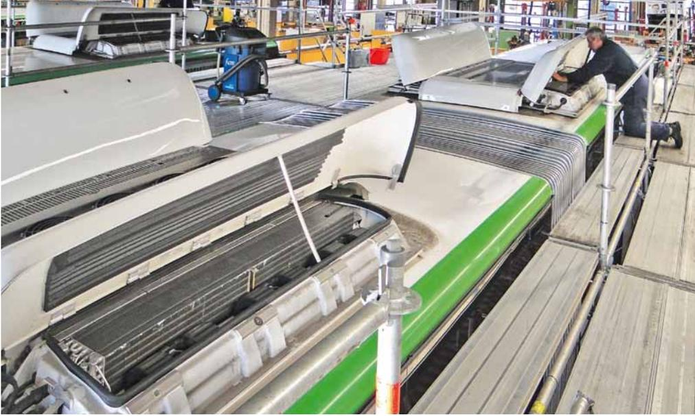
Für die Instandsetzung der Aggregate auf dem Fahrzeugdach sind verschiedene Lösungen für Dacharbeitsstände im Einsatz.
