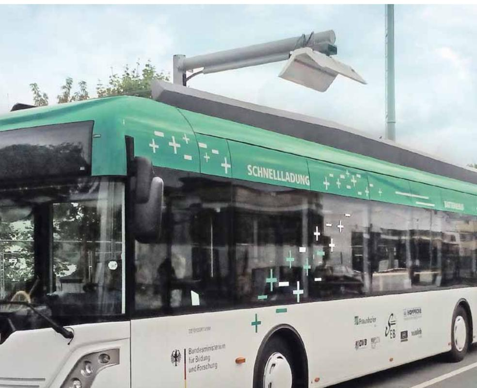
Beim Ladevorgang am Elektrobus muss darauf geachtet werden, dass der Pantograf (Stromabnehmer) nicht unter Spannung angelegt wird, um zu verhindern, dass Lichtbögen entstehen. Beim Fahren von Elektrofahrzeugen kann eine Gefährdung von Personen durch die Geräuschlosigkeit des Antriebs entstehen.
