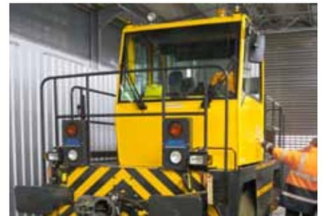
Dieses Zweiwegfahrzeug ist mit automatischen Mittelpufferkupplungen ausgerüstet. Ein Monitor-Kamera-/Monitorsystem ermöglicht dem Fahrer den Blick auf die rückseitige Kupplung, ohne dass er aufstehen muss.
