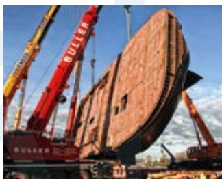
SCHWERSTARBEIT: Der Rumpf wird um 180 Grad gedreht.
