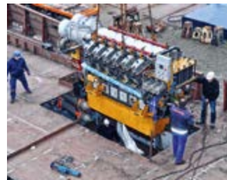
MASCHINE: Einer der beiden ABC-Hauptmotoren mit 2.249 kW.
