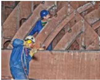
SKELETT: Der Schlepper wird in Sektionsbauweise gefertigt.
