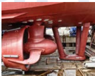
UNTERSCHIFF: Die beiden Schottel- Ruderpropeller und die Dockstütze.
