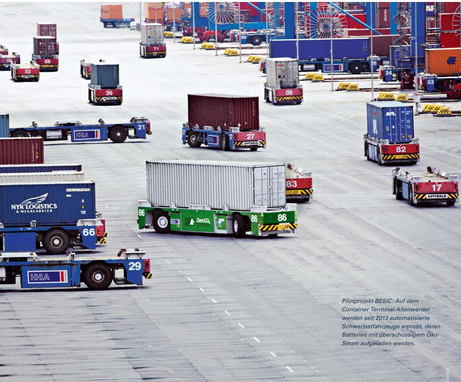
*Pilotprojekt BESIC: Auf dem Container Terminal Altenwerder werden seit 2013 automatisierte Schwerlastfahrzeuge erprobt, deren Batterien mit überschüssigem Ökostrom aufgeladen werden.*
