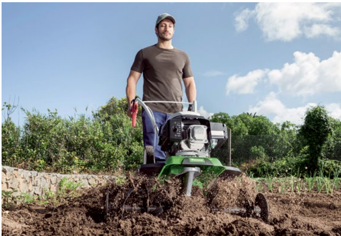
Das neue Antivibrationssystem der VIKING Motorhacken, hier das Modell HB 685, schont die Gelenke: In den Holm integriert, verringert es die Übertragung der Schwingungen vom Getriebe auf den Lenker. (Foto: VIKING)
