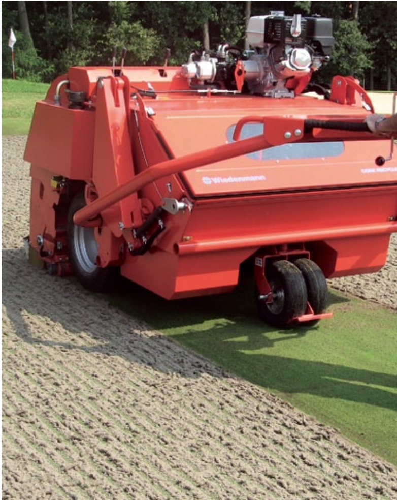
Der Core Recycler nimmt die ausgestochenen Erdkegel auf, trennt Filz von Biomasse, und bürstet letztere wieder in den Boden ein (Foto: Wiedenmann)
