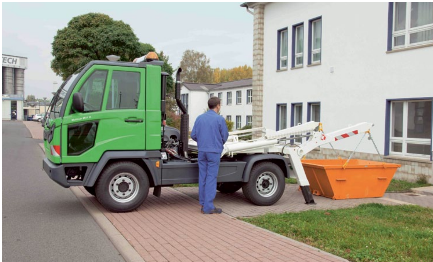
Dank 7,5 t Gesamtzuggewicht und vielen Ladeoptionen ist der Multicar M31 Zwei in Einem: professioneller Geräteträger und vollwertiger Transporter. (Fotos: Hako GmbH)
