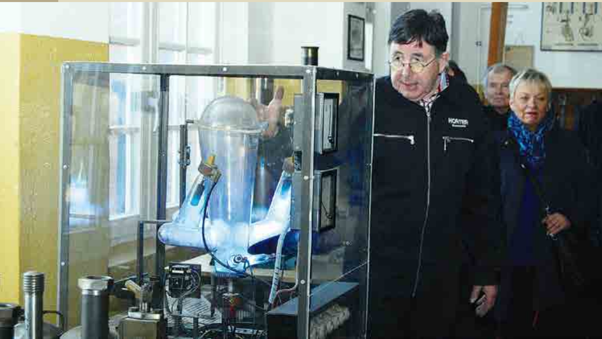
Ein Quecksilber-Dampfgleichrichter in Aktion. Peter Horter erläutert, wie über dieses Verfahren aus Wechselstrom Gleichstrom erzeugt wird.
