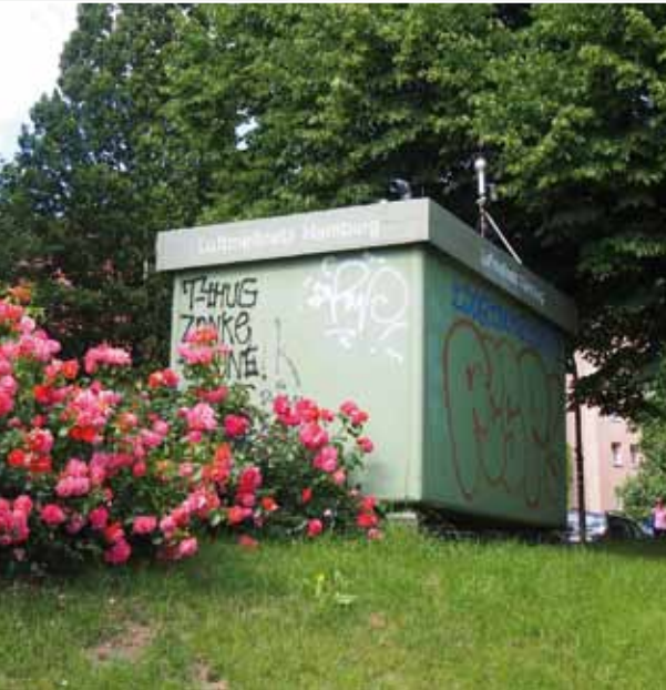
Ende 2011 wurde die HaLm-Messstation Altona-Elbhang im Olbersweg in Betrieb genommen. Sie misst permanent \text{NO}_2 , \text{NO} , \text{SO}_2 , \text{PM}_{10} und Benzol.
