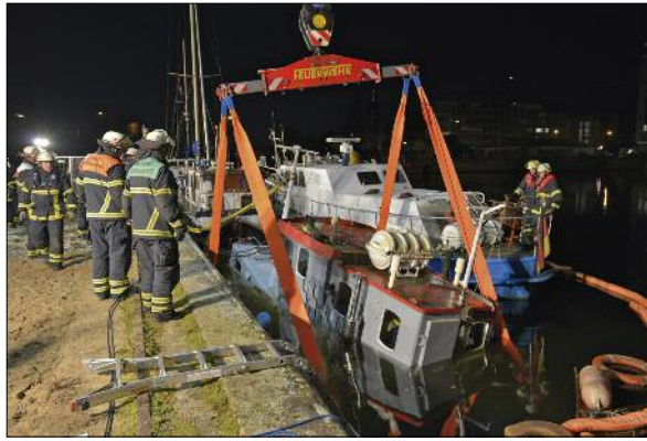
02.11.2014, THWAK, HARBURG: Kutter circa 10 x 4,5 Meter aus ungeklärter Ursache im Hafenbecken gesunken. Ausbringen von Ölschlängeln um Ausbreitung ausgelaufener Betriebsstoffe auf dem Wasser zu verhindern. Bergung des Havaristen mittels Feuerwehrkran
