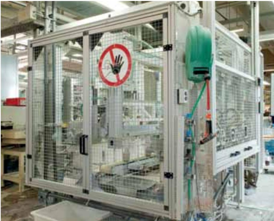
An dieser Maschine ist alles korrekt. Generell darf es zu keinen manipulierten Schutzeinrichtungen kommen, sonst ist die Arbeitssicherheit extrem gefährdet.
