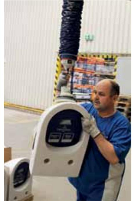
Die Hebehilfe erleichtert die Palettierung der Fertigware enorm.
