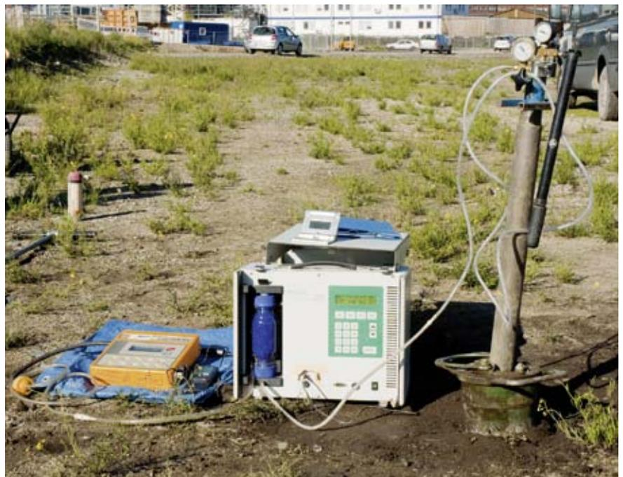
Messsystem bestehend aus Packer-sonde, Pumpe und Deponiegasanalytator
