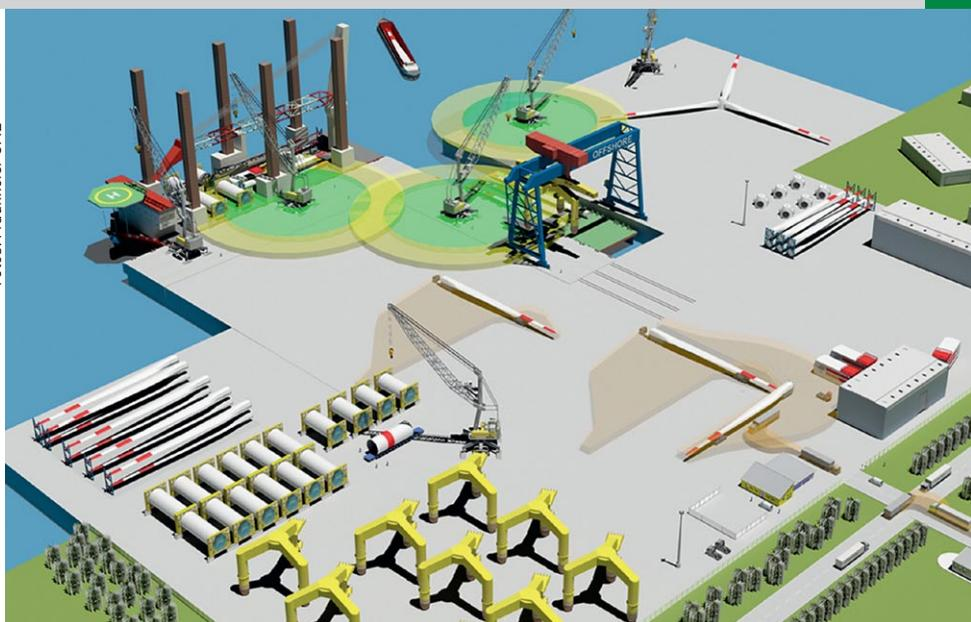
Bild 2: Visualisierung von Wende- und Arbeitsbereichen in einem virtuellen Offshore-Terminal.
