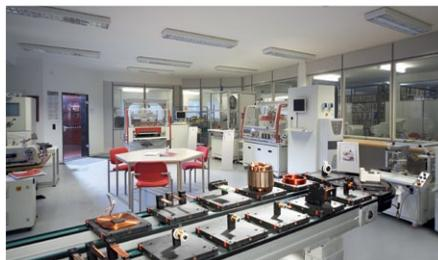
i-Tüpfelchen in Sachen High-Tech: Aumann testet im neuen Technikum neue Produktionstechnik im Kleinserien-Betrieb. So werden beispielsweise testhalber Elektromotor-Bauteile wie Statorn bewickelt.
