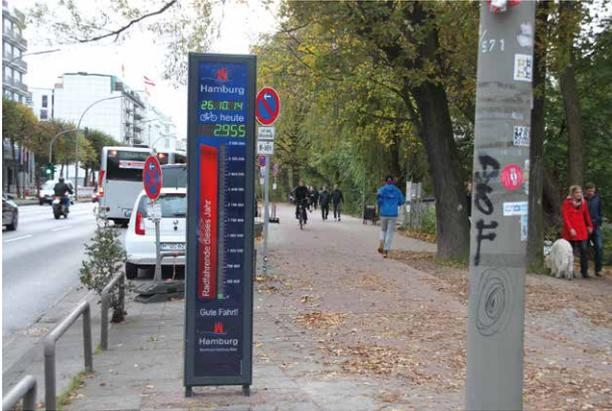
Gemessen wird über eine im Boden verlegte Induktionsschleife. Auf dem Display abzulesen sind außerdem die Jahressumme der Radfahrer sowie Datum, Uhrzeit und Umgebungstemperatur. Zusätzlich erfasst die Station Wetterdaten und die Radfahreranzahl zu den unterschiedlichen Tageszeiten.
