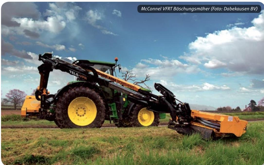
Landwirte, Kommunen, kommunale Dienstleister oder Lohnunternehmer. Da sich die Maschinen mit verschiedenen Anbaugeräten wie z.B. Schlegelrotor, Hecken- und Astschere oder Kreissäge ausrüsten lassen, wird eine große Einsatzvielfalt geboten. Eine automatische Boden Anpassung auf unebenem Boden wird durch das patentierte EDS System - serienmäßige elektronische Schwimmstellung des Mährotors und Auslegerarms - gewährleistet.
