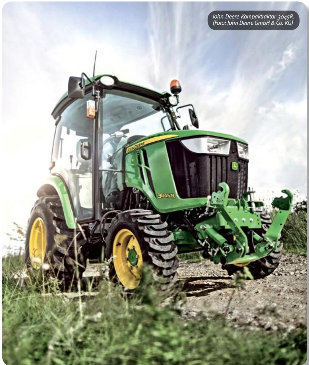
Mit leichtgängigen Hydraulikhebeln lassen sich Frontladerarbeiten komfortabler ausführen bzw. die Frontanbaugeräte der Dreipunkthydraulik präziser steuern. Für den leichteren, bequemeren und sichereren Aufbau von Geräten in der Dreipunkthydraulik am Heck sind die Ankoppelpunkte ab Werk mit Kugel und Fanghaken erhältlich.
