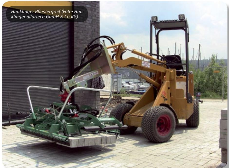
Mit "Maschinell Pflastern" verbindet man in Deutschland für gewöhnlich entweder die herkömmliche Verlegemaschine oder den Bagger als Trägermaschine. Viel weniger verbreitet ist hierzulande die Kombination Lader mit Pflastergreifer. Woran liegt das?
