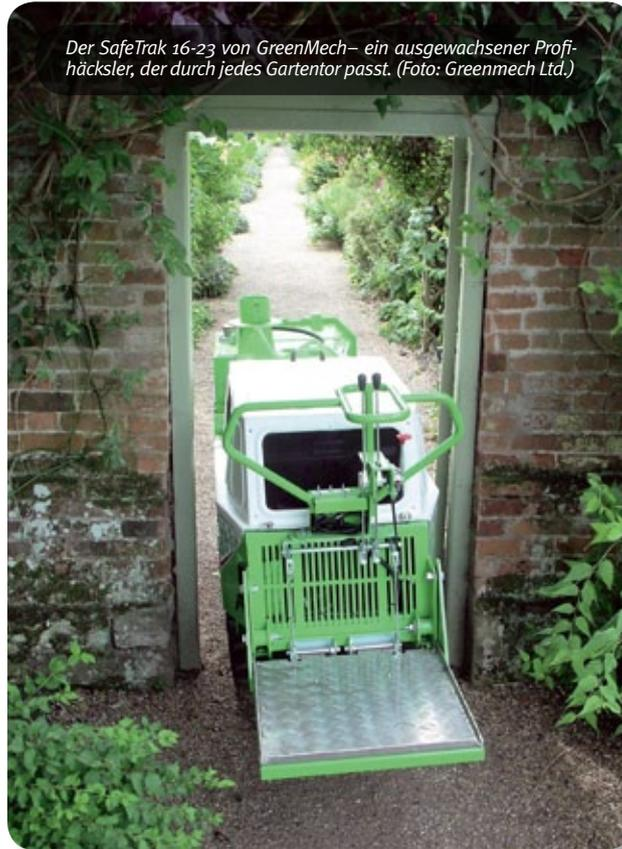
bei auf bis zu 73 cm Breite und der Häcksler wird um einen Meter kürzer. Gartentore mit einer üblichen Breite von 80 cm stellen damit kein Hindernis mehr dar.
