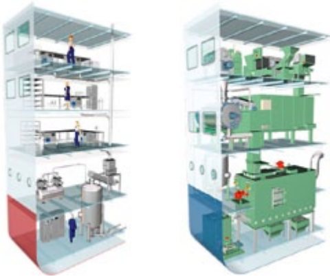
VERNETZT: Die verschiedenen Stationen und Komponenten des Müll-Management-Systems sind über mehrere Decks – unter anderem durch Vakuum-Leitungen – effektiv miteinander verbunden.
