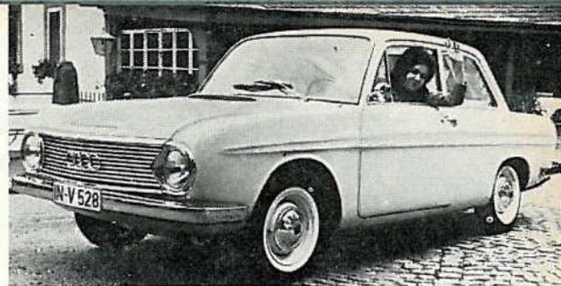
Wer DKW sagt, meint Frontantrieb und Zweitaktmotor. Auch der neue „Heuler“ aus Ingolstadt, der mit dem Werbeslogan „Formel des Fortschritts“ angepriesene DKW F 102 — bleibt bei dieser schon Tradition gewordenen Konstruktionsregel. Ob das allerdings auch in Zukunft so bleiben wird, kann heute schon aus vielerlei Gründen bezweifelt werden. Denn eins ist sicher:
