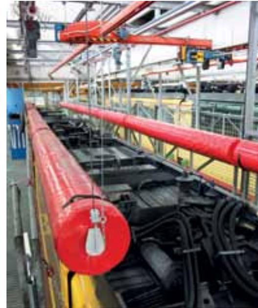
Die absenkbaren Formkörper der Lösung der Verkehrsbetriebe Karlsruhe verschließen die Spalten neben dem Fahrzeugdach und verhindern einen Absturz.
