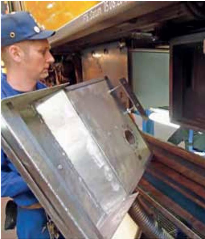
Durch die leichte Bauweise der von den Berliner Verkehrsbetrieben entwickelten Adapter, können diese von nur einer Person montiert werden.
