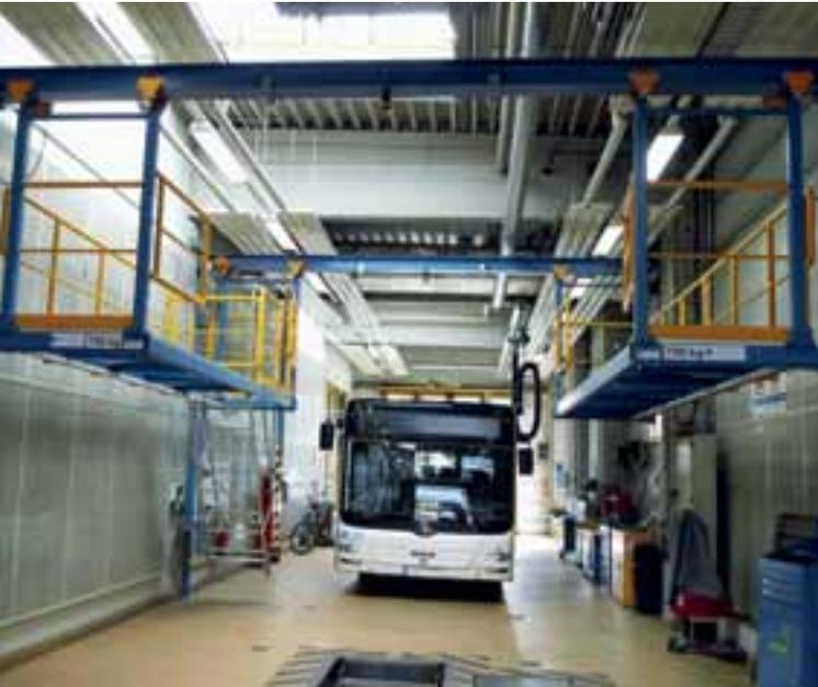
Die quer verfahrbare Arbeitsbühne verhindert Schäden am Fahrzeug. Die Anlage der Jenaer Nahverkehr GmbH ermöglicht einen sicheren Zugang durch eine Treppe.
