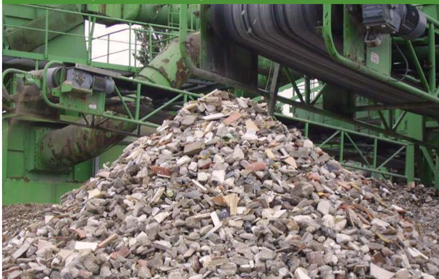
Bauschutt: Sortieranlage für die Wiederverwendung.
