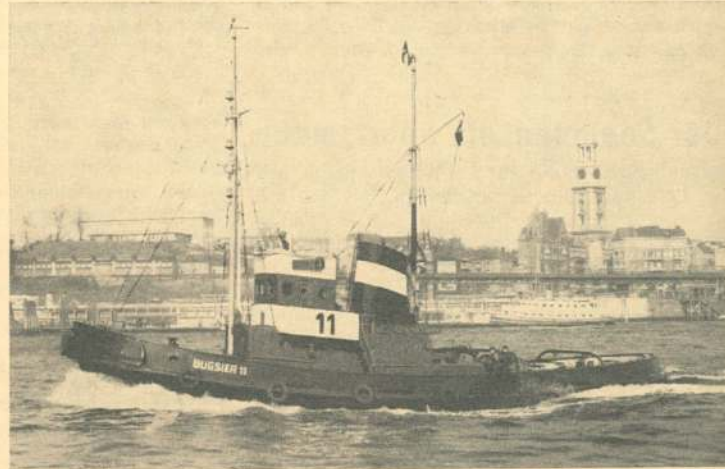
Die Schichau-Werft hat sich in Bremerhaven besonders auf einen wohlgelungenen Schleppertyp spezialisiert, wie ihn die „Bugsier 11“ darstellt. Länge 26,7 m, Breite 6,15 m, 86 BRT, 850 PSe. Rund 25 solcher Motorschlepper sind seit 1952 gebaut worden.
