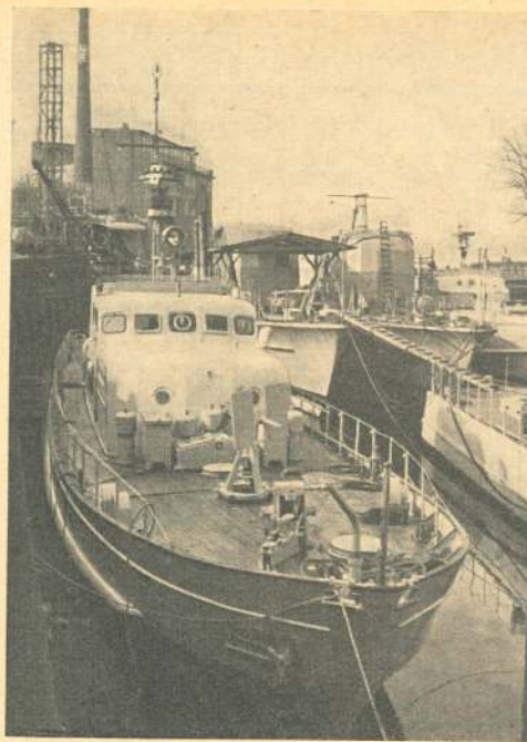
Eines der französischen Küsten-Patrouillenboote im Bau auf der Lürssen-Werft, Bremen-Vegesack. Länge 31 m, Breite 5 m, zwei Dieselmotoren mit zusammen 2700 PS, 28 Knoten. Bewaffnung zwei 2-cm-Oerlikon SK. Im Hintergrund zwei schwedische Schnellboote.
