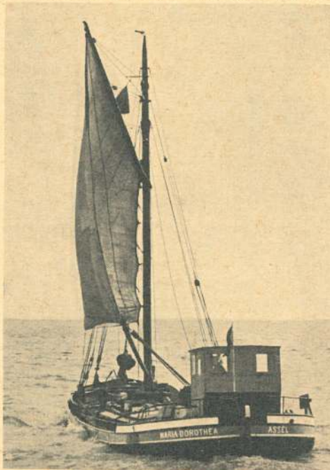
Ewer „Maria Dorothea“ aus Assel, 1907 in Elmshorn aus Eisen erbaut, 41 BRT, 27 NRT, 25 PS, 2 Mann Besatzung. Solche Schiffe waren an der ganzen deutschen Nordseeküste beheimatet. Ursprünglich reine Segler, erhielten sie erst in den 20er Jahren Motoren.
