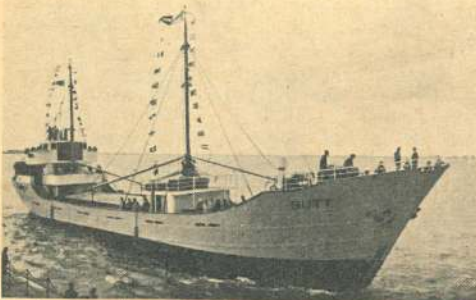
Das MS. „Butt“ von Kapitän Julius Feldtmann, Hamburg-Moorende, stellt den jetzigen Typ eines Küstenmotorschiffes dar. 1954 von J. J. Sietas, Hamburg-Neuenfelde erbaut, vermißt es 421 BRT und 705 t d.w. 300 PS, 9 Knoten. Svendborg-Rudermaschine und HAGENUK-Funkstation. 8 Mann Besatzung. Drei Ladebäume zu je 2 t.
