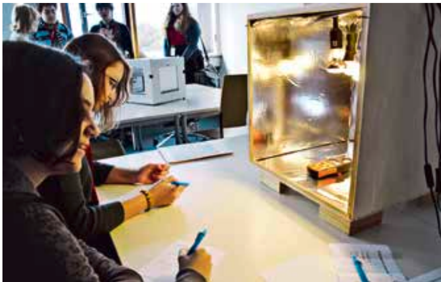
Wie ist die Lichtausbeute? In der Lampenbox lässt sich das per Luxmeter ermitteln.
