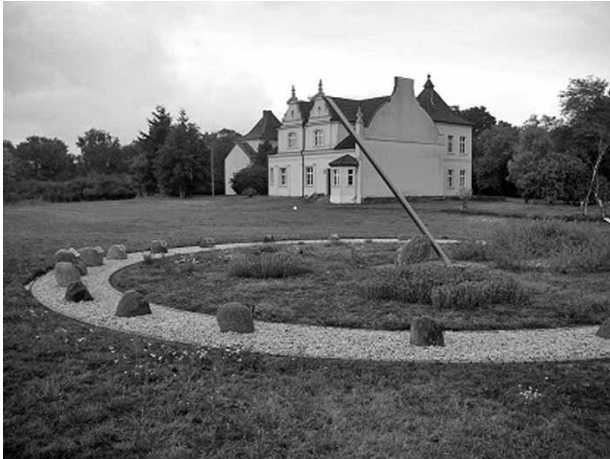
Abb. Bild 8: Wieder hergestellte horizontale Sonnenuhr mit Polstab auf dem Anwesen Briest bei Tangerhütte in der Altmark; aufgenommen am 10.10.2013, Foto: Joachim Reinhardt
