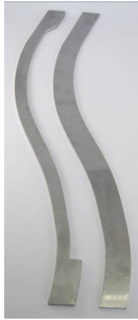
Vorher: Halbzeug-Einzelbleche für die Triebwerksschaufel-Vorderkante
