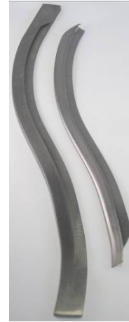
Nach dem Diffusion Bonding: Links ein diffusionsgeschweißtes Halbzeug und rechts eine daraus zu fertigende Triebwerksschaufel-Vorderkante
