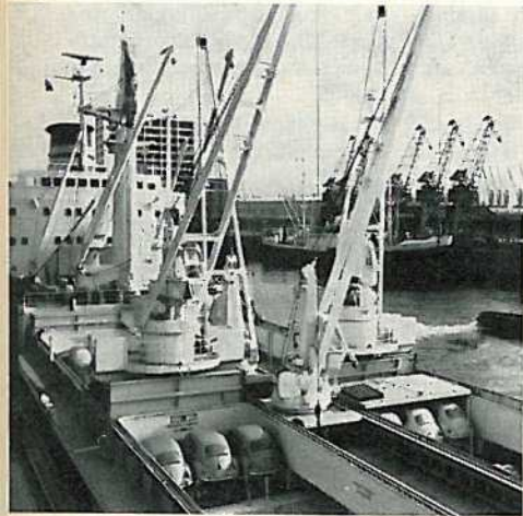
Fier weg, — und das Kollo ist schon verstaut. Diese Anordnung von Luken und Kränen, der mittlere ist ein Laufkran, gestattet auf den norwegischen „offenen Schiffen“ zu 90 Prozent das Absetzen der Ladung am endgültigen Platz im Laderaum. Die Hälfte der Umschlagszeit wird eingespart, auch weil die Seitenkräne unmittelbar auf Eisenbahnwaggons langen können (links).
