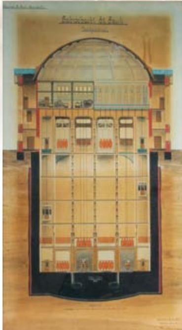
Insgesamt verschlang der Bau dieses historischen Wahrzeichens der Ingenieurbaukunst etwa 200 Tonnen Blei, 5.000 Tonnen Eisen und 600.000 Nieten. Pro Schacht führen sechs Fahrstühle nach unten auf das Tunnelniveau: Davon je zwei mit 10 und 6 Tonnen Tragkraft für Fahrzeuge sowie zwei Personenaufzüge mit je 2,4 Tonnen Zuladung. Hinzu kommen Fußgängertreppen in beiden Schächten.
