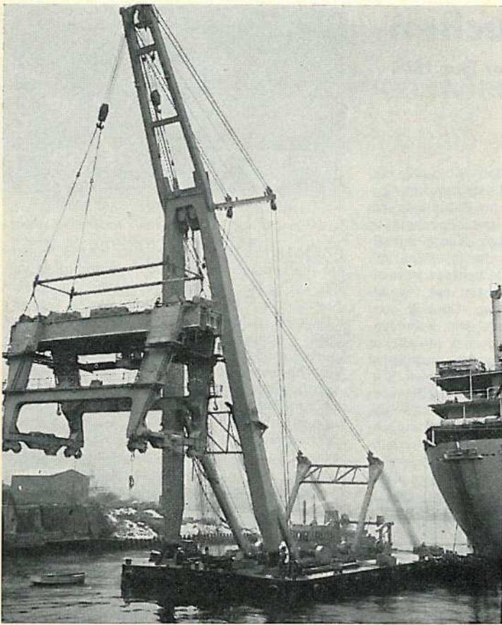
Dieser Schwimmkran wurde von den Kieler Howaldtswerken gebaut und im Januar dieses Jahres in Dienst gestellt. Er verfügt bei der maximalen Belastung von 400 t noch über eine Auslage von 8 m und eine Hubhöhe von 28 m. Beim
