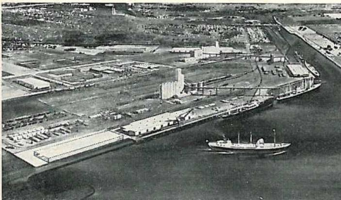
So wird der neue Überseehafen von Sacramento nach Fertigstellung der gegenwärtigen Ausbaustufe aussehen. Vorne fünf Liegeplätze für Überseeschiffe, im Hintergrund rechts ein Bootskanal mit Schleuse zum Sacramento River.
