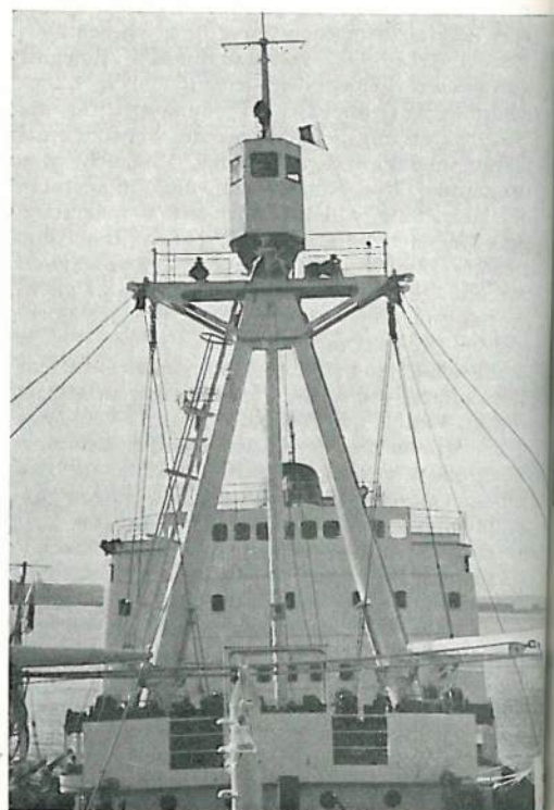
Kommandoelemente, Ruderanlage und Kontrollinstrumente hoch über dem Schiff mit Vollkreisrundblick und vollkommen wettergeschützt: die Mastkabine, ideal für Schiffsführung und Ausguck.
