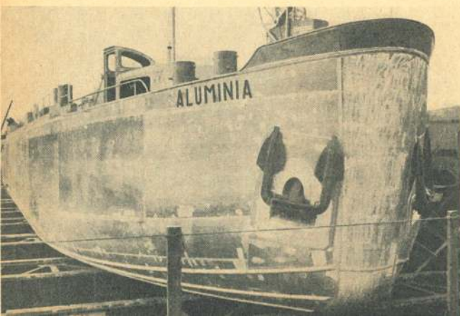
Auf der Staatswerft in Rendsburg/Saatsee lief kürzlich der erste ausschließlich aus Aluminium gebaute Binnentanker vom Typ „Gustav Königs“ vom Stapel. Auftraggeber ist eine Reedergemeinschaft, an der die Montan Transport Ges. m.b.H. und die Vereinigten Deutschen Metall Werke A.G., Frankfurt/Main, beteiligt sind.
