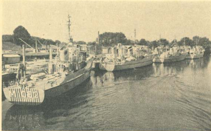
Sieben Küstenminensuchboote der Bundesmarine liegen hier an der Ausrüstungskaje der Burmestierwerft in Bremen-Burg. Zwei davon sind Neubauten, die gerade die ersten Erprobungsfahrten hinter sich haben, die übrigen gehören dem 6. Minensuch-Geschwader an und sind zur turnusmäßigen Überholung an die Werft gekommen. Die Küstenminensuchboote sind so gut wie unmagnetisch. Der Rumpf ist aus Holz verleimt und alle Metallteile aus Aluminiumlegierungen und Bronze, selbst die Anker.
