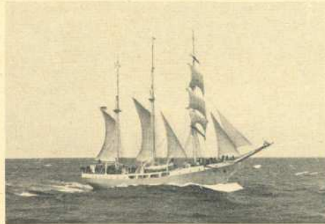
Die 810 ts große Schonerbark „Dewarutji“ wurde 1953 von der Stülckenwerft, Hamburg, als Seekadetten-Schulschiff für die Kriegsmarine Indonesiens erbaut. 50 m lang, 9,5 m breit, 4,2 m Tiefgang. 1091 qm Segelfläche, Dieselmotor 600 PS. 32 Mann Stammbesatzung und 72 Kadetten.
