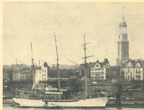
Die Dreimastbarkentine „Jadran“ ist das Segelschulschiff der südslawischen Kriegsmarine. Als „Marco Polo“ wurde sie 1932 auf der Stülckenwerft, Hamburg, erbaut. 720 ts, 50 m lang, 8,8 m breit, 4,3 m Tiefgang, 800 qm Segelfläche, 375 PS Dieselmotor. 150 Kadetten.
