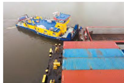
„NASSE UMFUHR“: Verband aus Schubschiff und mit Containern beladenen Leichtern.
