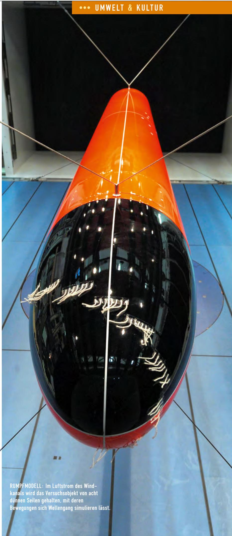
**RUMPFMODELL:** Im Luftstrom des Windkanals wird das Versuchsobjekt von acht dünnen Seilen gehalten, mit deren Bewegungen sich Wellengang simulieren lässt.
