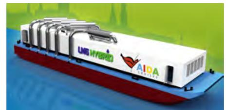
VERSORGUNG: Die Energie wird auf der LNG-Hybrid-Barge in Blockheizkraftwerksmotoren und Generatoren mittels Flüssiggas (LNG) erzeugt.
