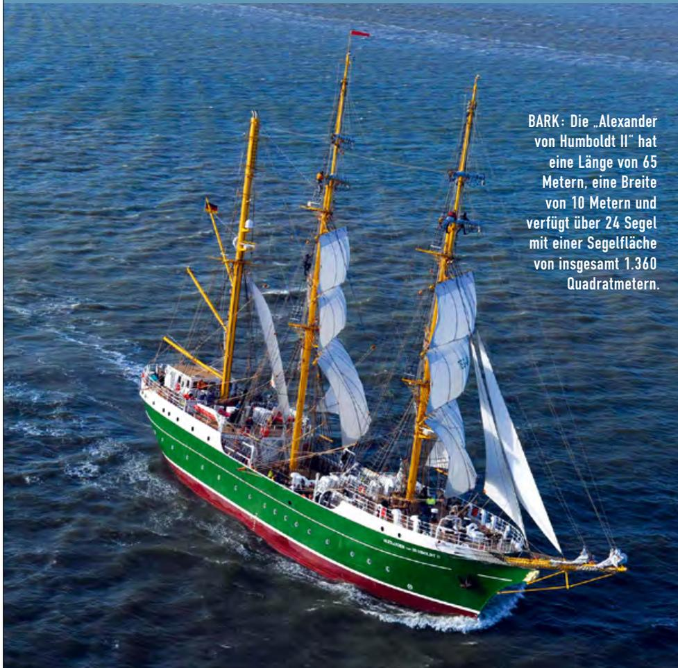
**BARK:** Die „Alexander von Humboldt II“ hat eine Länge von 65 Metern, eine Breite von 10 Metern und verfügt über 24 Segel mit einer Segelfläche von insgesamt 1.360 Quadratmetern.
