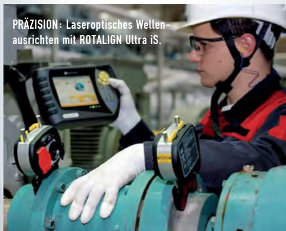
**PRÄZISION:** Laseroptisches Wellenausrichten mit ROTALIGN Ultra iS.
