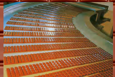
FORMGEBUNG: Nach dem Conchieren gelangt die flüssige Masse zu der Eintafelanlage.
