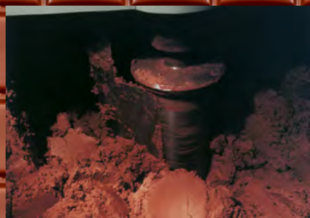
KNETVORGANG: Die warme Kakaomasse wird in eine Mischanlage gepumpt und gerührt.
