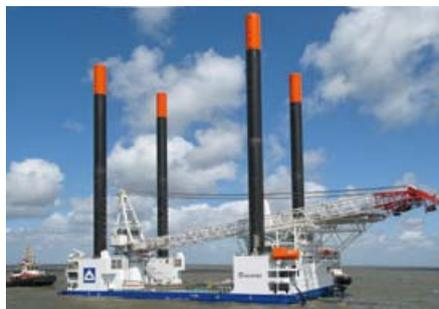
**HUBPLATTFORM:** Das Hochtief-Schiff „Thor“ verfügt über einen 400-Tonnen-Kran.
