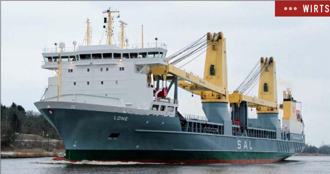
**ALLESKÖNNER:** Der neue SAL-Schwergutfrachter „Lone“ wurde aufwendig für die Offshore-Montage nachgerüstet – unter anderem mit moderner DP-Technik.
