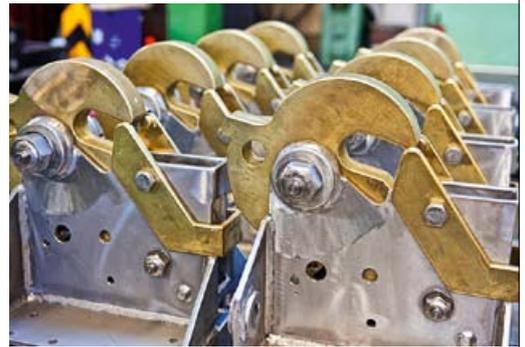
**KNACKPUNKT:** Für die Sicherheit kommt es besonders auf die reibungslose Funktion der Heißhaken an, an denen die Boote aufgehängt sind. Die sogenannte Round-Cam-Auslösung der deutschen Hersteller hat hier große Fortschritte in puncto Sicherheit gebracht.
