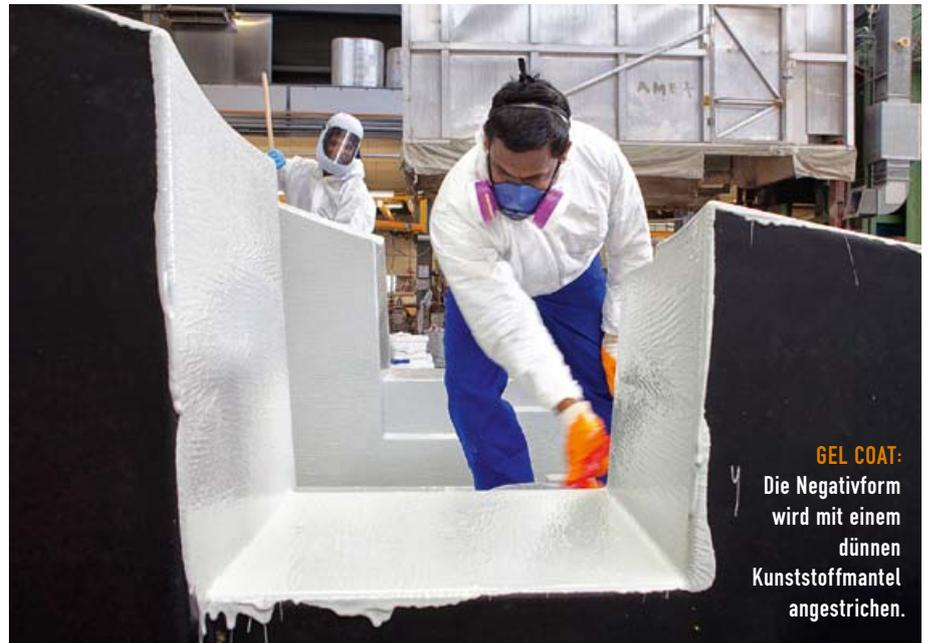
**GEL COAT:** Die Negativform wird mit einem dünnen Kunststoffmantel angestrichen.
