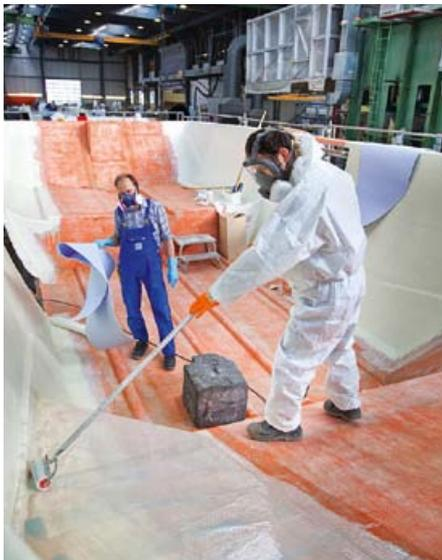
**MOBILITÄT:** Glasfaserschichten werden aufgelegt und mit Spezialharz verfestigt.
