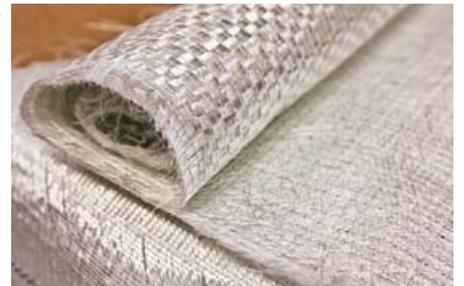
**EXPERTISE:** Rund 170 Mitarbeiter fertigen bei Hatecke Rettungsboote, die seit den 1960er-Jahren vorwiegend aus Kunststoff bestehen. Der Einsatz von Glasfasermatten macht das Material widerstandsfähig. 1983 wurde hier das erste Freifall-Rettungsboot entwickelt.
