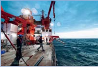
PROBE: GEOMAR-Forscher lassen ein Schwerelot auf den Meeresboden.
