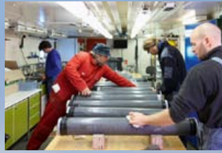
ENTNAHME: In einem Kunststoffrohr wird die Probe aus dem Lot gezogen.
