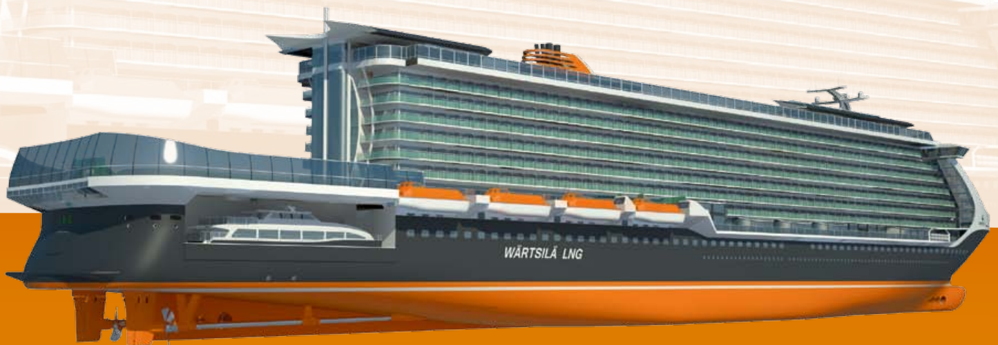
CHARAKTER. Kennzeichen des Designkonzepts sind der kurze Aufbau und ein breiter, langer Rumpf.
