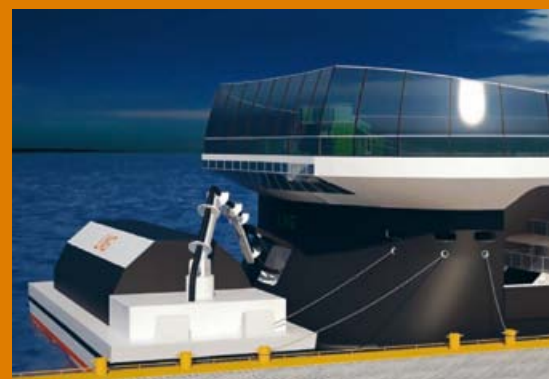
TANKSTELLE. Das Kreuzfahrtschiff bei der LNG-Bunkerung mit einer speziellen Barge.
