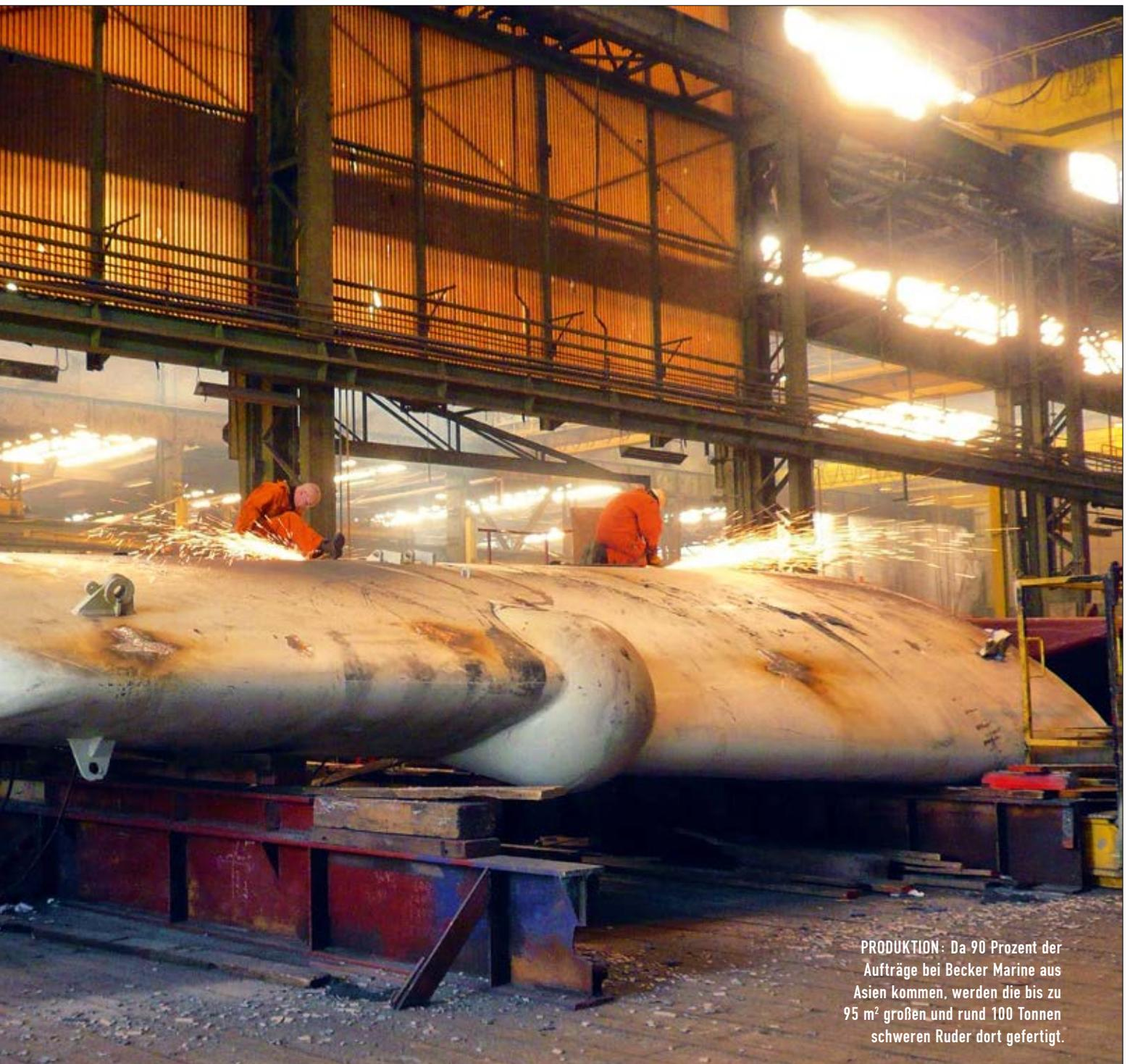
PRODUKTION: Da 90 Prozent der Aufträge bei Becker Marine aus Asien kommen, werden die bis zu 95 m<sup>2</sup> großen und rund 100 Tonnen schweren Ruder dort gefertigt.
