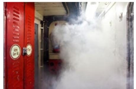
**NEBELWERFER:** Binnen Sekunden vernebeln sie die engen Flure im Schiffsbauch und erschweren den Piraten die Orientierung.
