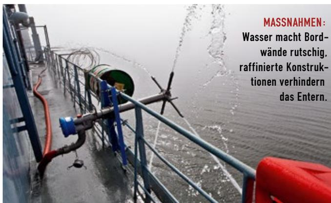
**MASSNAHMEN:** Wasser macht Bordwände rutschig, raffinierte Konstruktionen verhindern das Entern.
